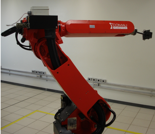
Figura 2: Manipulador COMAU SmartSix em uma tarefa de calibração.
